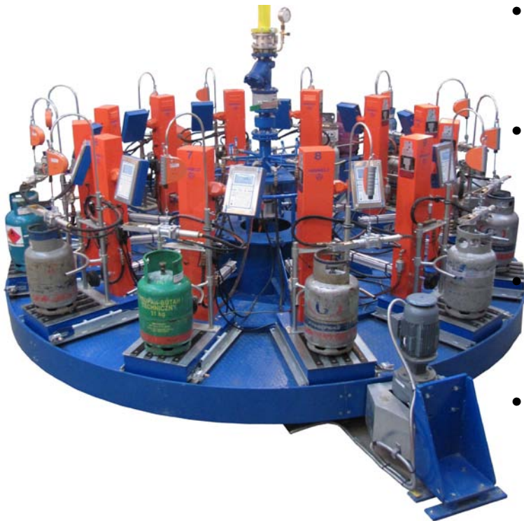
Typischer Aufbau eines Füllkarussells
